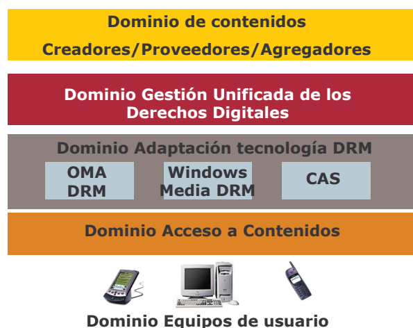
Figura 21. Arquitectura multi DRM de referencia
