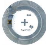
Tag HF (13,56 MHz) de Texas Instruments en forma redonda para CD o DVD
